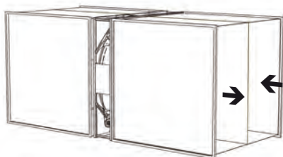
Montage im Klimagerät obere Abb. zeigt Luftstromtrennung nebeneinander
