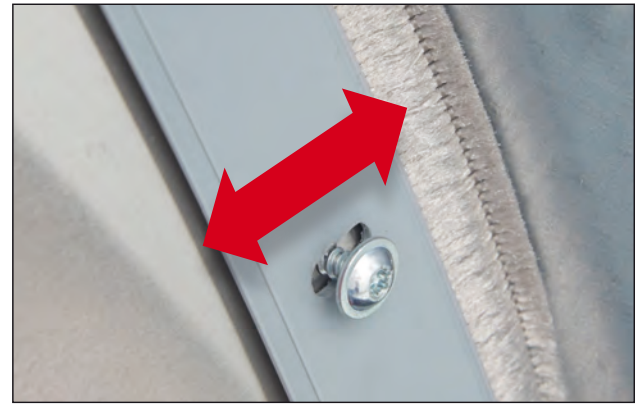
Die Umfangsdichtung ist mittels Langloch am Dichtungsträger auf der Speichermasse verstellbar. Damit kann die Dichtung optimal zwischen Speichermasse und Gehäuse abgedichtet werden.
