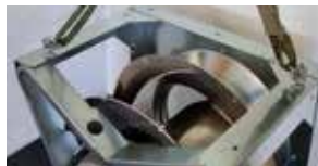
Montage von Hebeösen an dafür vorgesehenen Stellen
