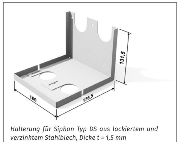
Halterung für Siphon Typ DS aus lackiertem und verzinktem Stahlblech, Dicke  $t = 1,5$  mm
