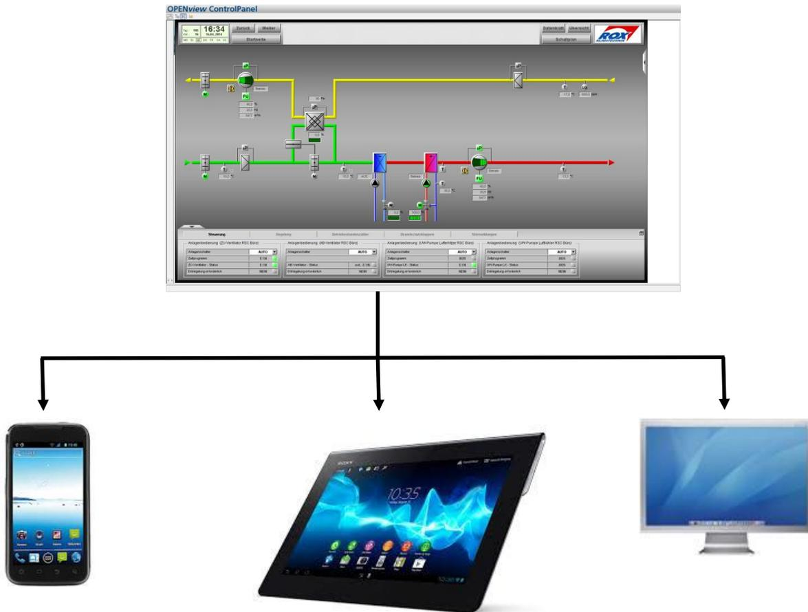
Auf die Anlage kann ebenfalls über WLAN zugegriffen werden. An den oben beschriebenen Geräten können alle Funktionen des RLT-Gerätes geschaltet werden.
