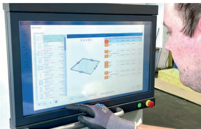
Bendex-Software macht Vorschläge zur Biegestrategie, der Positionierung der Werkzeuge und steuert den Biegeablauf.
